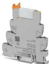
PLC-INTERFACE, composto da morsetto base PLC-BSC.../21 con connessione a vite e relè in miniatura a innesto con contatto di potenza, per montaggio su guida di supporto NS 35/7,5, 1 contatto di scambio, tensione di ingresso 230 V AC/220 V DC
