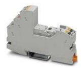
Base per relè RIF-1..., per relè di potenza in miniatura con 1 o 2 contatti di scambio o relè a stato solido equivalenti dal punto di vista costruttivo, connessione Push-in, possibilità d'innesto per modulo d'ingresso/antidisturbo, per il montaggio su NS 35/7,5
