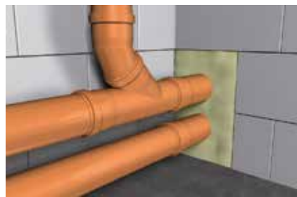
Riempimento di attraversamenti di tubazioni
