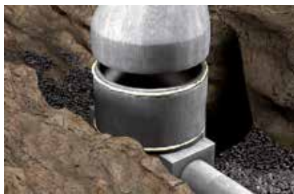
Sigillatura anelli di pozzetti di calcestruzzo
