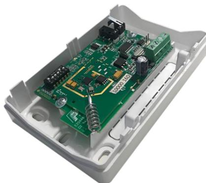
Moduli ricetrasmittitori radio che permettono di utilizzare i dispositivi wireless elencati nelle centrali Comelit della serie VEDO. Permettono l'utilizzo di fino a 32 sensori, 16 sirene e 32 telecomandi radio. Alloggiato in contenitore plastico antifiamma colore bianco completo di tamper antiapertura e anti-strappo escludibili. E' possibile alloggiarlo anche all'interno dei contenitori art. BOXPLASTIC, BOXMETAL e BOXFLUSH. Dimensioni (L x H x P) 126 x 80 x 32 mm.
