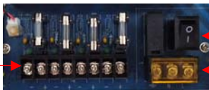
ANSCHLUSSLEISTE SPANNUNG- VERSORGUNG KAMERAS 12V (DC)(+, -)
